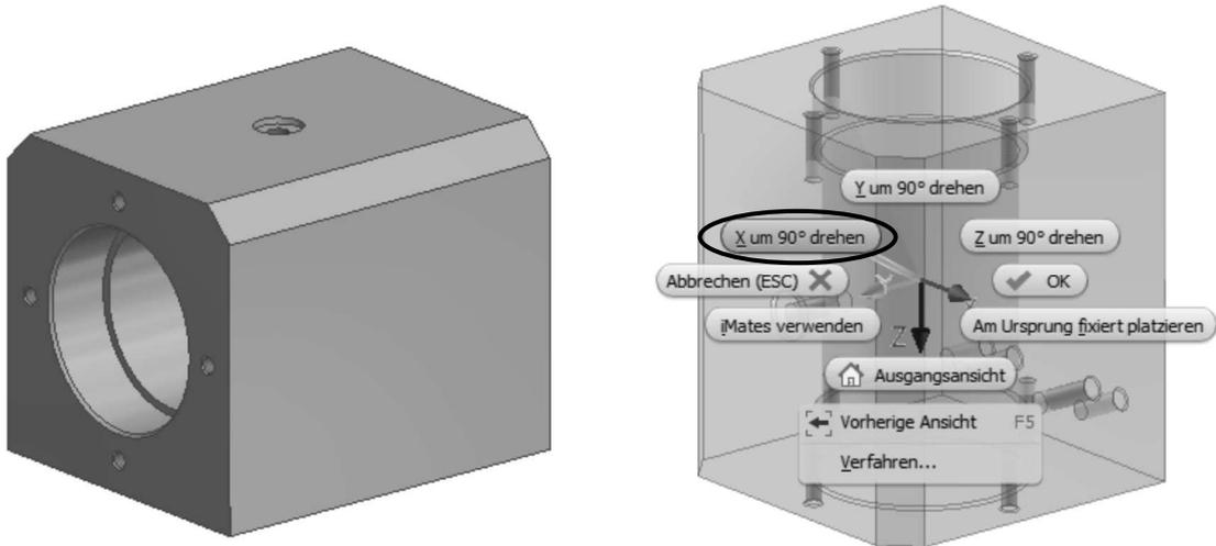
Über das Mini-Menü können Sie angeben, ob die zuzuordnende Komponente über die **X-, Y- oder Z-Achse** gedreht positioniert werden soll. Des Weiteren können Sie über die Funktion **Am Ursprung fixiert platzieren** angeben, ob die zuzuordnende Komponente über deren Ursprungsebenen an den Ursprungsebenen der Baugruppendatei fixiert positioniert werden soll. Nach dem die zugeordnete Komponente fixiert wurde, wird dies im Browser über eine Pinnadel **Gehaeuse: 1** angezeigt.
