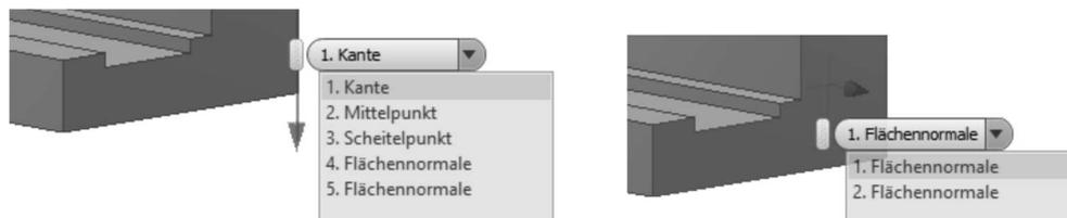
Um die Wartezeit auf das Auswahlmenü zu verkürzen, können Sie nach Selektion einer Kante / Fläche über das Kontextmenü und dem Befehl **Andere auswählen...** das Auswahlmenü selbständig öffnen.
