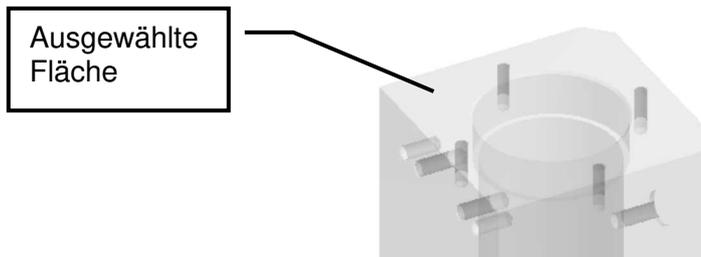
Nach Auswahl der Fläche wird sofort das Bauteil im Browser angelegt. Wurde der Schalter **Skizzierebene von gewählter Fläche oder Ebene abhängig machen** aktiviert, wird sofort eine Zusammenbauabhängigkeit zwischen den zwei Bauteilen vergeben. Erstellen Sie nun über den Befehl **2D-Skizze** eine Skizzierebene.
