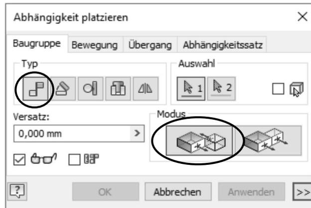
Abb.: Dialogbox **Abhängigkeit platzieren** Register **Baugruppe** Modus **Passend**
