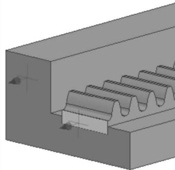
Verwenden Sie Grenzwerte von Abhängigkeiten zum Definieren des zulässigen Bewegungsbereichs für Komponenten, die per Drag & Drop verschoben oder gedreht werden. Sie können Werte für Maximum, Minimum und die Ausgangsposition angeben.
