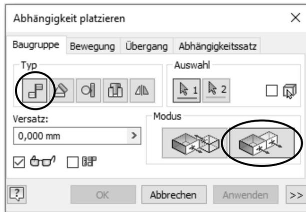
Abb.: Dialogbox **Abhängigkeit platzieren** Register **Baugruppe** Modus **Fluchtend**
