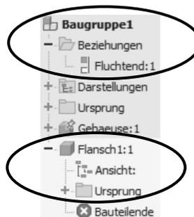
Über den Schalter **Virtuelle Komponente** wird ein Bauteil ohne Modellgeometrie angelegt. Des Weiteren wird zu diesem Bauteil keine Datei erstellt.
