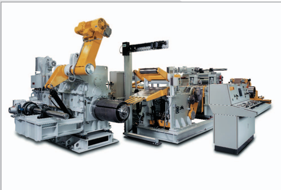
Bei der hpl-Neugnadenfelder Maschinenfabrik werden neue Produkte, wie diese Abwickel-Einheit einer Umspulanlage, komplett mit Autodesk Inventor entwickelt.
