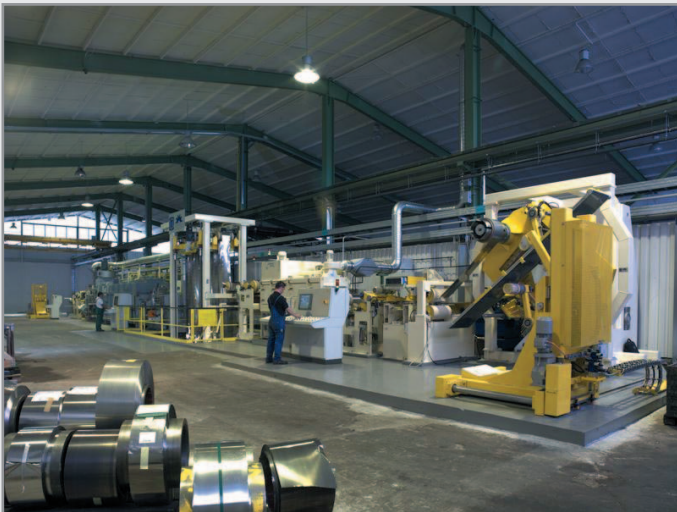
Die abgebildete Blankglühanlage erhitzt Metallbänder, um sie bearbeiten zu können.
